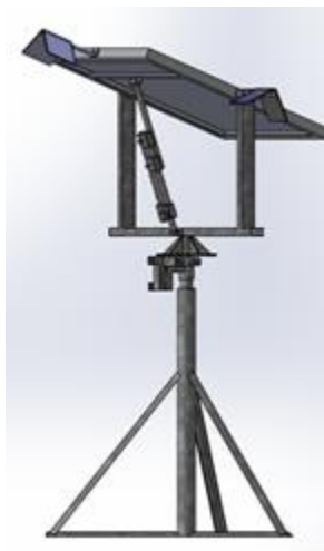
Figura 2. Estructura de soporte para el sistema fotovoltaico con seguimiento solar
