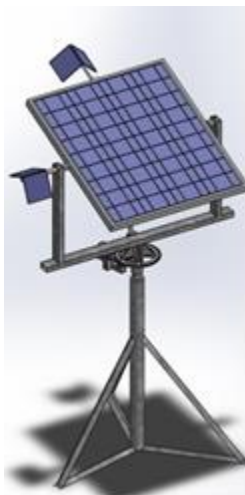
Figura 2. Estructura de soporte para el sistema fotovoltaico con seguimiento solar
