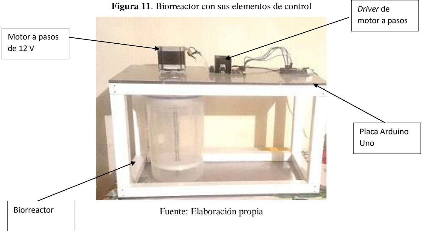
Figura 12. Elementos de control del nuevo biorreactor
