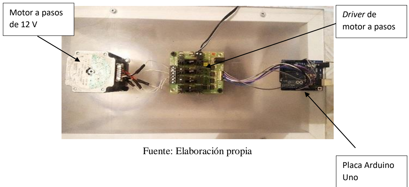
Figura 12. Elementos de control del nuevo biorreactor
